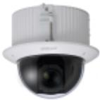
Speed dome IP Starlight 5" a incasso da interno antivandalo IK10 con riscaldamento, sensore CMOS progressivo 1/2.8", risoluzione 2 MP a 50/60fps, rotazione PAN 360° endless / TILT 0°~90°, auto flip 180°, H.265+, ICR, zoom ottico 25x (4.8~120 mm f1.6~4.4) /
