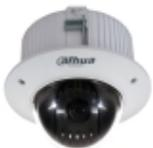
Mini PTZ IP Starlight da interno antivandalo IK10 a incasso, sensore CMOS Starvis progressivo 1/2.8", risoluzione 2 MP a 25/30fps, rotazione PAN 360° endless / TILT -2°~90°, auto flip 180°, H.265+, ICR, zoom ottico 12x (5.3~64 mm *f* 1.6~4.4) / 16x digitale,
