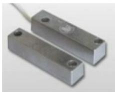
Contatto magnetico in alluminio di potenza per montaggio a giorno Uscita NC con magnete vicino. Portata contatto 200 Vcc/ 1 Amp. Tipo di connessione a 4 fili con tamper. Gap 21/14 mm. Grado di protezione IP65. Temperatura di funzionamento: -25°C / +70°C. Omologato IMQ I° Livello, Vds G191590 Cl.B
