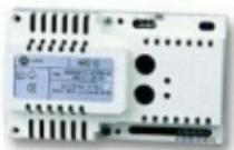
Alimentatore lineare con tensione in uscita stabilizzata Montaggio DIN rail| Circuito di protezione tensione in entrata e uscita| Tensione primaria 220Vac / 50Hz| Tensione secondaria 12 Vdc /1A Stabilizzati e con filtro di protezione| Tensione secondaria 12 Vac / 0,35A| Dimensioni: L 142 x H 92 x P 60mm
